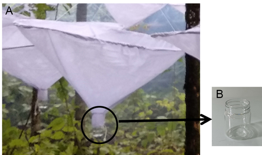
图 3. 白布漏斗法。A. 白布漏斗；B. 塑料收集瓶
