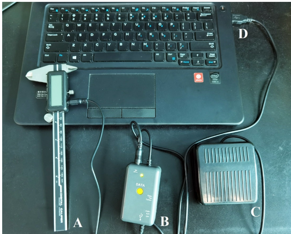
图 1. 带有电脑数据传输装置的电子数显游标卡尺 A. 电子数显游标卡尺；B. 转换装置；C. 脚踏装置；D. USB 连接线插口
